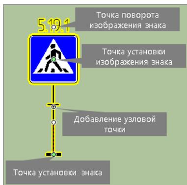
Для изменения положения дорожного знака на плане выделите его и перетащите точку установки знака на новое место (это действие повлияет на отображение знака на плане и в 3D-виде).
