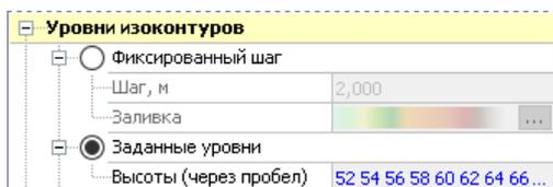
Цвета для отображения изоконтуров выбираются случайным образом. Чтобы изменить цвет для некоторого диапазона высот, щёлкните мышью на соответствующей строке в дереве проекта, а затем в инспекторе объектов выберите подходящий цвет.
