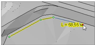
Измерение площадей/периметров выполняется в режиме
