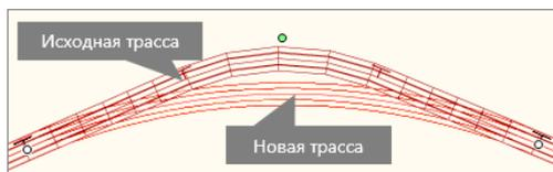
5. Чтобы завершить редактирование, перейдите в любой другой режим работы. Удобнее всего перейти в режим правки объектов, нажав клавишу **Esc**. Изменение плановой геометрии трассы, разбитой на поперечные профили, затрагивает различные данные, запроектированные в других проекциях: продольный профиль, поперечные профили и пр. Поэтому по завершении редактирования нужно подтвердить вносимые в трассу изменения в появившемся диалоговом окне.
