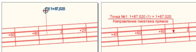
Для создания точки изменения пикетажа в разделе параметров **Пикетаж**, в строке **Точки изменения пикетажа** нажмите кнопку **+**. Курсор на плане примет вид прицела с перпендикуляром к трассе, рядом с которым отображается текущее пикетажное положение. Щёлкните мышью в точке с нужным пикетажным положением.
