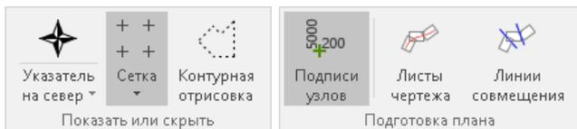
Для выборочного создания подписей узлов сетки включите режим **Чертежи и ведомости > Подготовка плана > Подписи узлов**. Щелчками мыши укажите те узлы сетки, которые требуется подписать. Если подписи не отображаются на плане, включите опцию **Подписывать узлы** в свойствах объекта **Сетка**. Чтобы удалить подпись, щёлкните мышью на узле ещё раз.
