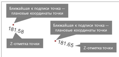
Создание точек с помощью блоков происходит следующим образом. На изображении DXF-/DWG-подложки осуществляется поиск текстовых подписей, содержащих допустимые значения Z-отметок точек.
