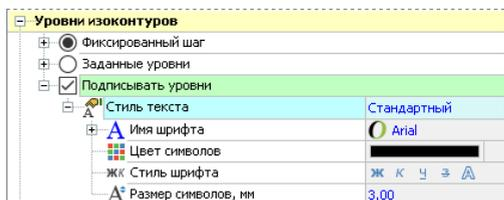
Чтобы изоконтурные линии не строились на участках, уклон которых превышает заданный, установите флаг **Не строить на участках с уклоном более** и укажите предельное значение уклона. Для плавного отображения изоконтуров можно их сгладить, установив соответствующую опцию.
