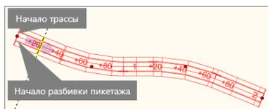
В системе IndorCAD реализованы два способа инвертирования трассы: с изменением и без изменения пикетажа. Для выполнения операции нажмите кнопку **Трассирование** >
