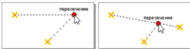
Чтобы зафиксировать точку привязки на пересечении дополнительных прямых или на середине отрезка, соединяющего две точки привязки, установите флажок **Создавать вспомогательные точки** и включите опции **На пересечениях прямых** и **На серединах отрезков**.
