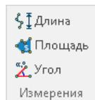
Чтобы измерить какое-либо расстояние на плане, включите режим  $\frac{\infty}{400}$  **Длина**. Последовательными щелчками мыши обозначьте на плане измеряемое расстояние. При этом рядом с указателем мыши отображается текущая длина линии. Чтобы отменить выбор последней
