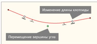
При включении опции **Биклотоидное сопряжение** система пытается перестроить модель к виду «клотоида — клотоида», сведя длину кривой к нулю и заменив её клотоидами. Если это невозможно выполнить при заданном радиусе, то об этом выдаётся соответствующее предупреждение.
