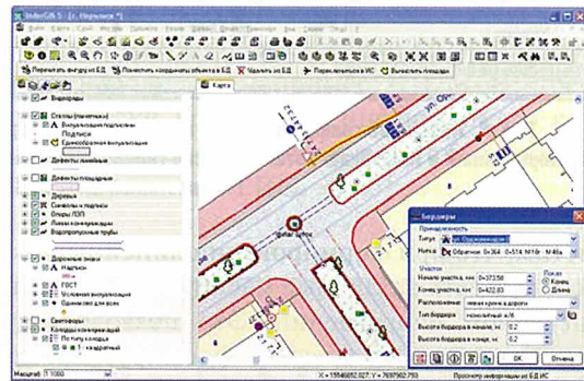
Рис. 2. Кадастровый план автомобильной дороги, сформированный в IndorGIS автоматически геоинформационной системой IndorGIS/Road на в IndorDraw связь с атрибутикой не сохраняется, т.к. основной целью этой операции является только высококачественная подготовка чертежей (рис. 3).
