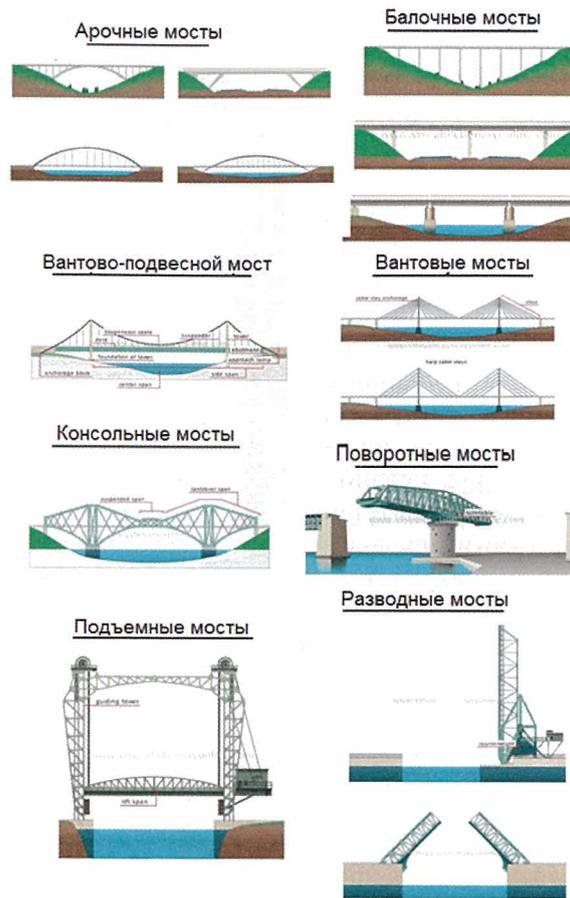
Рис. 7. Типы мостов, исследуемые в рамках проекта IFC-Bridge
